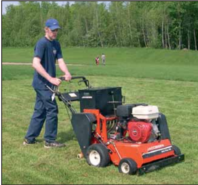
Figure 1. Sureensemenceur mécanique de type semoir-scarificateur (photo : S. Rochefort)
