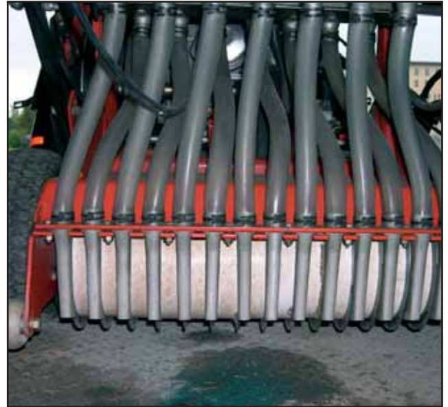
Figure 1. Sureensemenceur mécanique de type semoir-scarificateur (photo : S. Rochefort)
